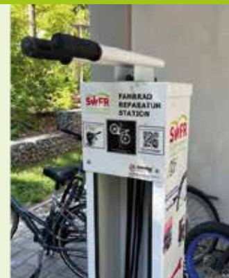
Fahrrad-Reparatursäule in der Studentensiedlung
